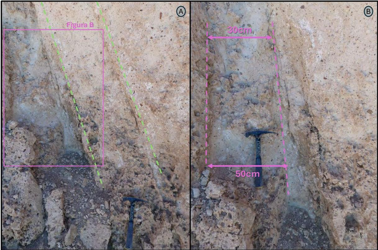
Figura 22: A) Fraturas Fr2 destacadas pelo tracejado verde, o quadrado rosa indica a posição da figura B. B) Planos limitando zona de brecha com farinha de rocha em tufo dacítico destacados por tracejado rosa. As dimensões da zona brechada são indicadas por flechas. Fonte: Interpretações do autor em fotos cedidas pelo projeto MASA.
