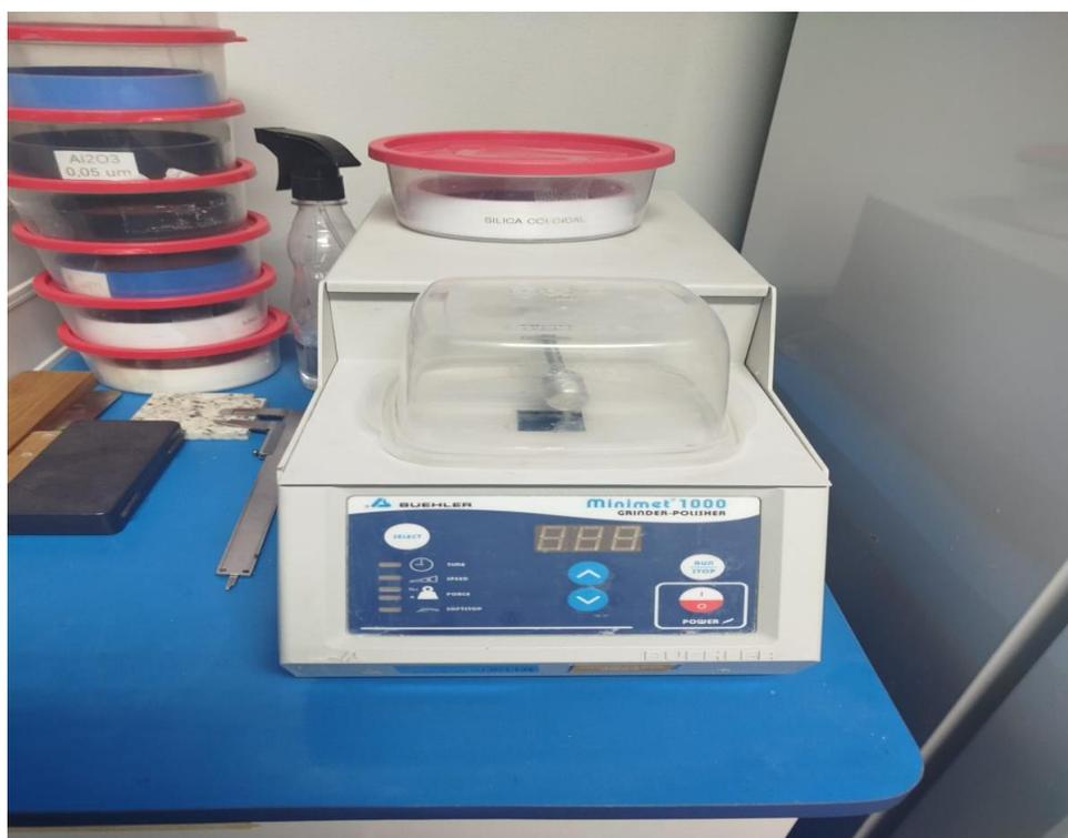
**Figura 5** - Politriz semiautomática MiniMet<sup>TM</sup> 1000 da marca Buehler disponível no CME/UFPR.
