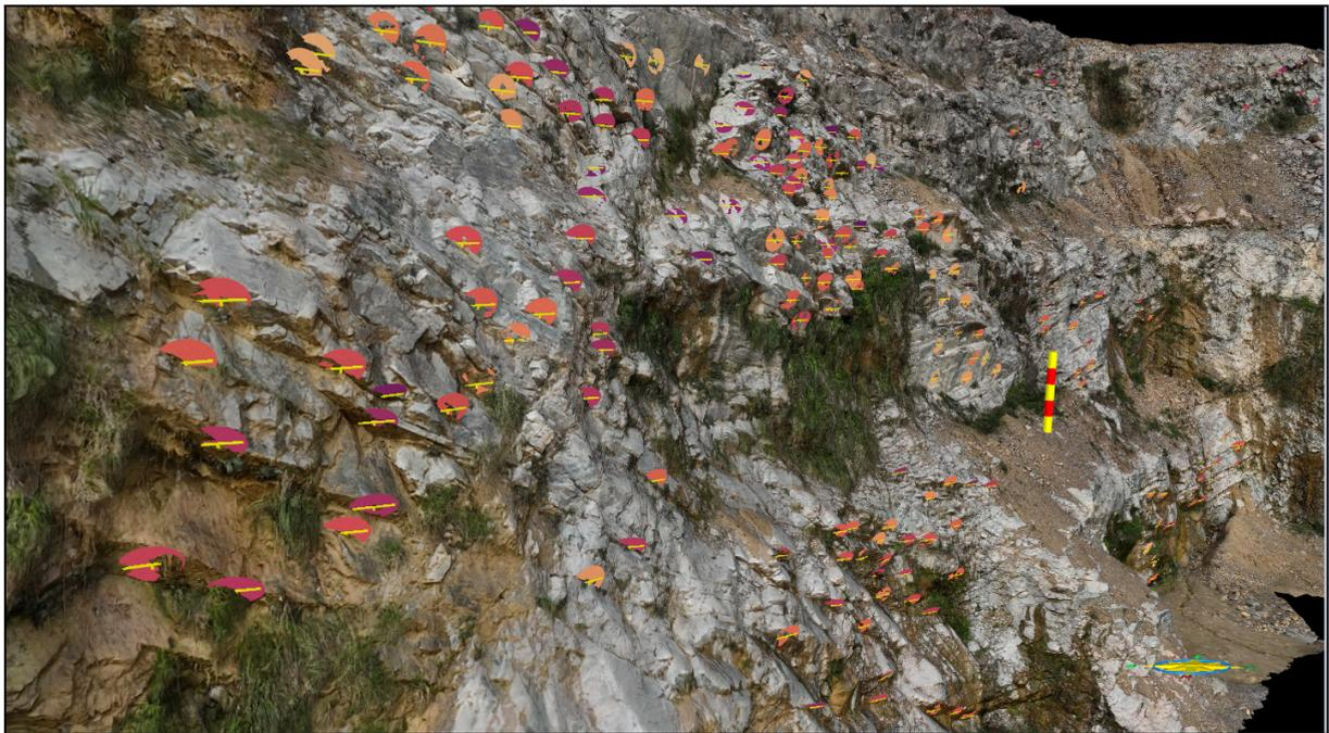
**Figura 16:** Porção do MDA em RGB destacando as estruturas traçadas com os respectivos elipsoides.
