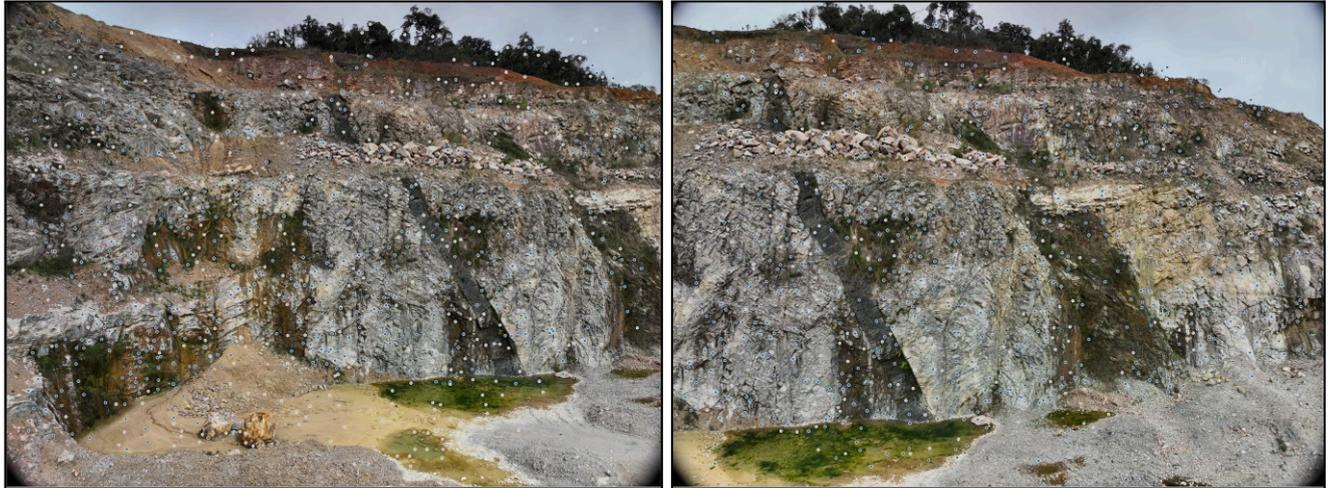
**Figura 11:** Imagens da mesma frente de lavra com pontos de visão diferentes, o *software* reconhece pontos em comum das duas imagens para fazer o alinhamento das fotos.
