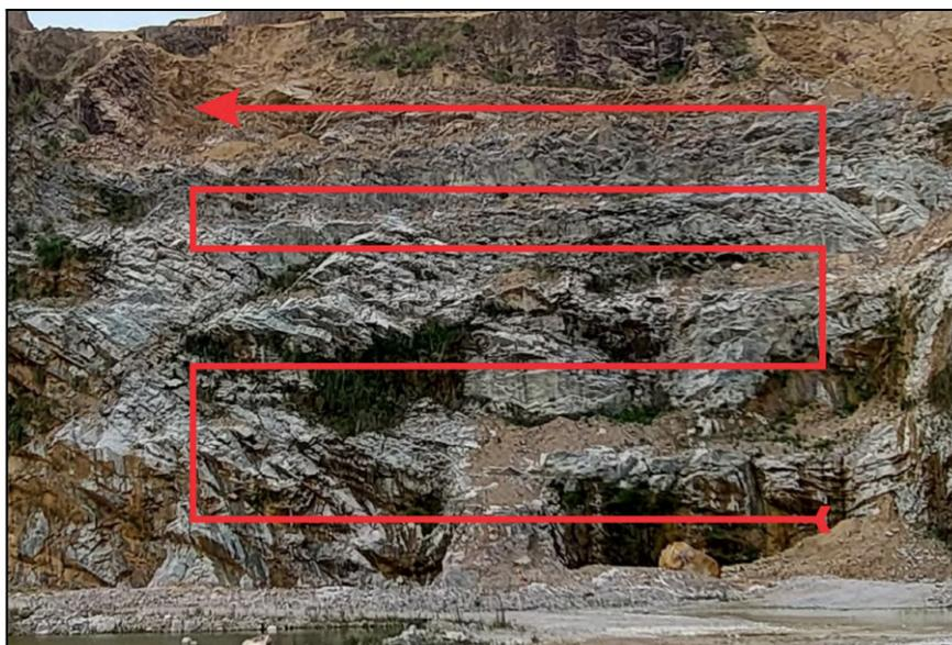
**Figura 9:** Trajeto percorrido pelo drone no voo manual, paralelamente às bancadas.
