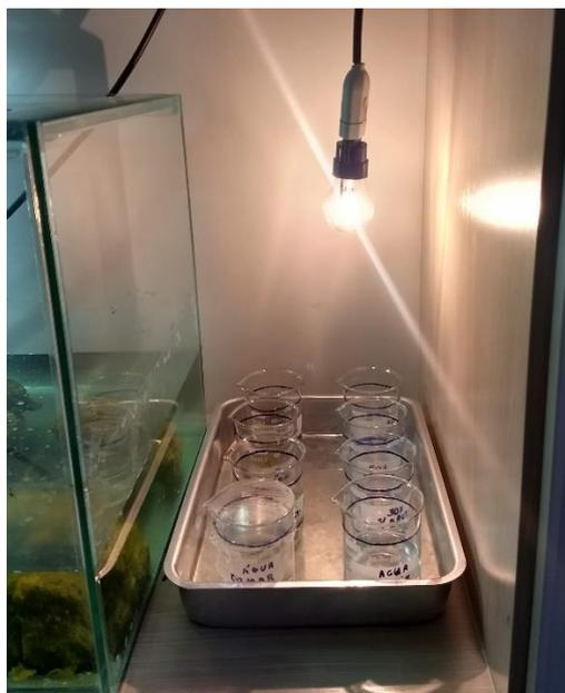
**Figura 6:** O experimento montado, oito béqueres e uma lâmpada 100W para aquecimento.
