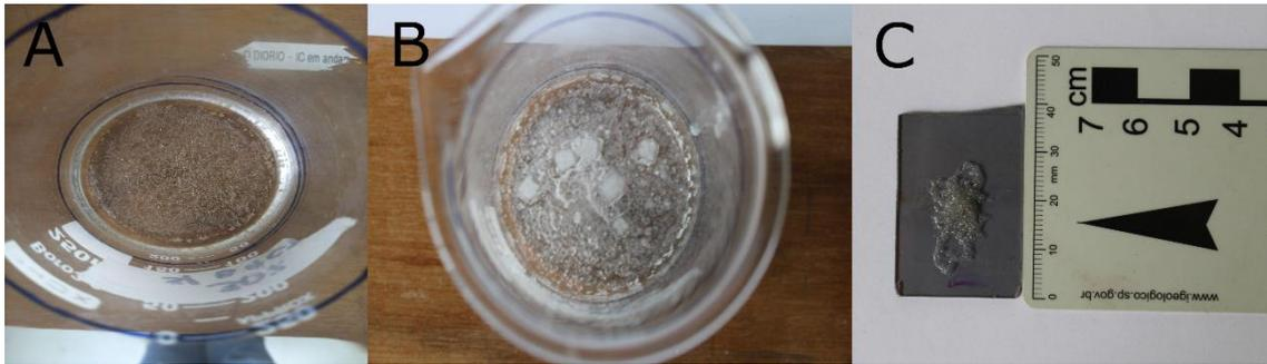
**Figura 17:** Diferentes taxas de evaporação da amostra 30% sem bactérias. a) primeiros precipitados formados em 78,75% de evaporação; b) cristais formados após completa evaporação da água; c) lâmina contendo microcristais para observação no MEV.
