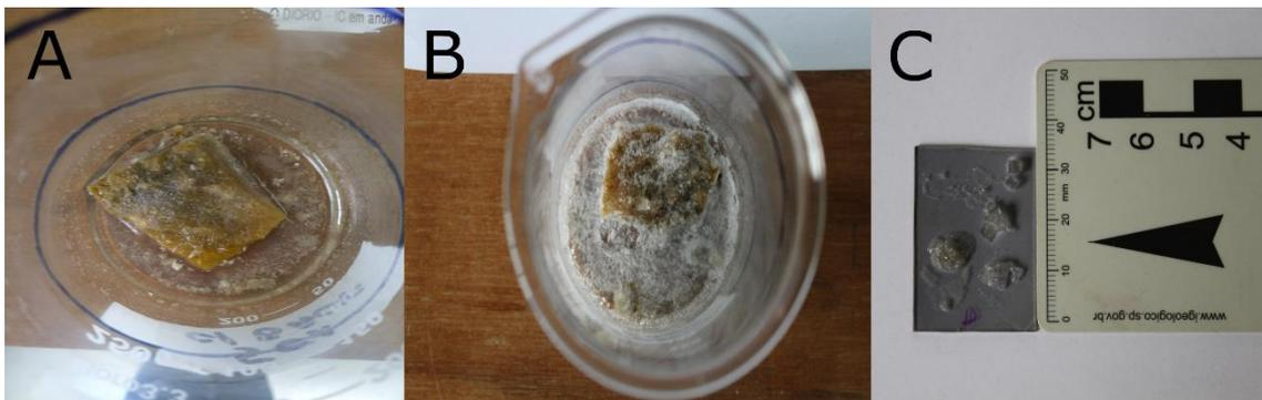
**Figura 14:** Diferentes taxas de evaporação da amostra 50% com bactérias. a) primeiros precipitados formados em 77,5% de evaporação; b) cristais formados após completa evaporação da água; c) lâmina contendo microcristais e cristais euédricos para observação no MEV.
