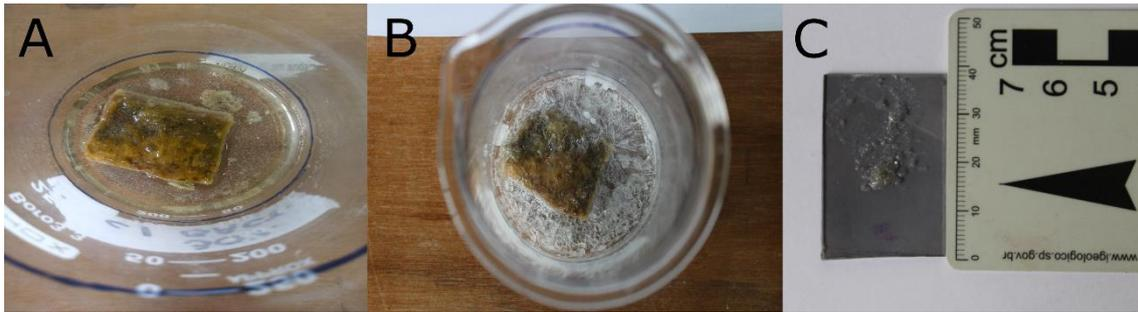
**Figura 19:** Diferentes taxas de evaporação da amostra 30% com bactérias. a) primeiros precipitados formados em 78,75% de evaporação; b) cristais formados após completa evaporação da água; c) lâmina contendo microcristais para observação no MEV.
