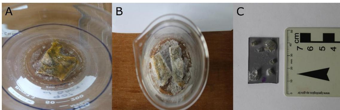
**Figura 10:** Diferentes taxas de evaporação da amostra 90% com bactérias. a) cristais anédricos formados em 85% de evaporação; b) divisão do estromatólito e formação de cristais euédricos de 2mm e microcristais anédricos após completa evaporação; c) lâmina confeccionada com cristais euédricos e anédricos.
