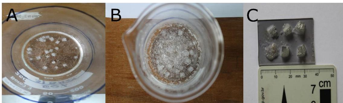
**Figura 12:** Diferentes taxas de evaporação da amostra 50% sem bactérias. a) primeiros precipitados formados em 81,25% de evaporação; b) cristais formados após completa evaporação da água; c) lâmina contendo microcristais e cristais euédricos para observação no MEV.
