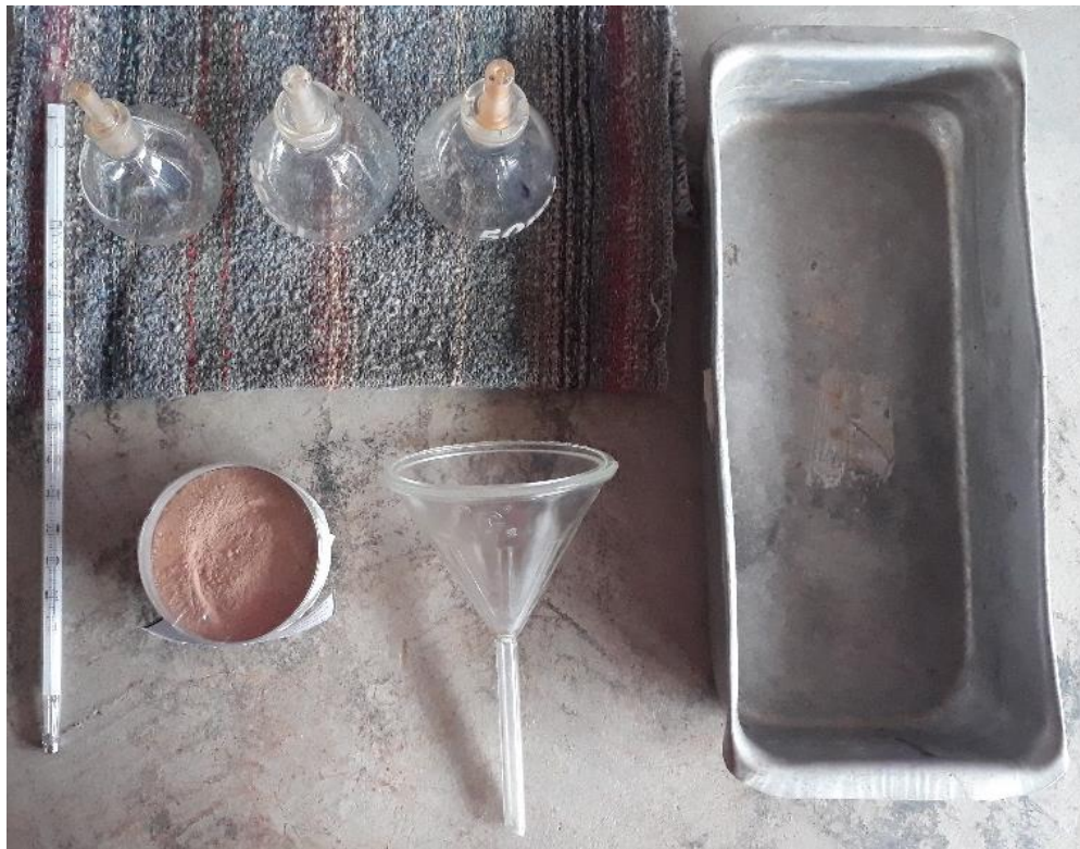
Figura 15: Parte dos utensílios utilizados no ensaio de determinação do peso específico dos grãos.
