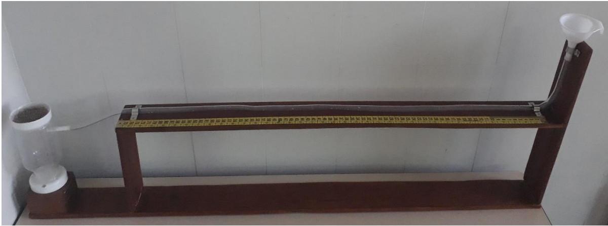
Figura 24: Equipamento utilizado no ensaio de absorção de água, confeccionado pela autora.
