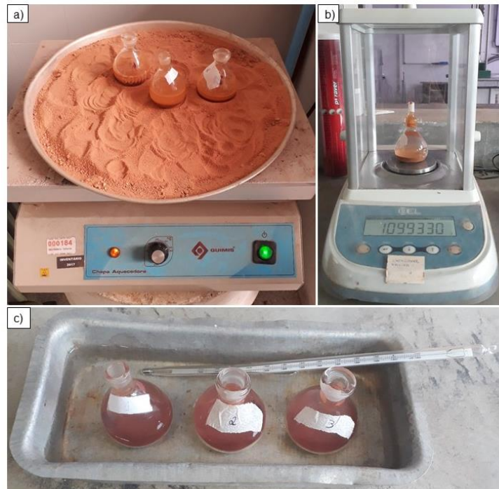
Figura 16: Ensaio de determinação do peso específico dos grãos. a) fervura das três amostragens na chapa térmica. b) pesagem do picnômetro após a fervura completo com água destilada. c) amostras resfriando por 15 min em banho com temperatura controlada.
