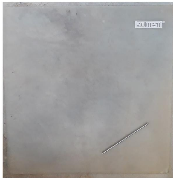
Figura 19: Placa porosa e gabarito utilizados para a realização do ensaio de Limite de Plasticidade.
