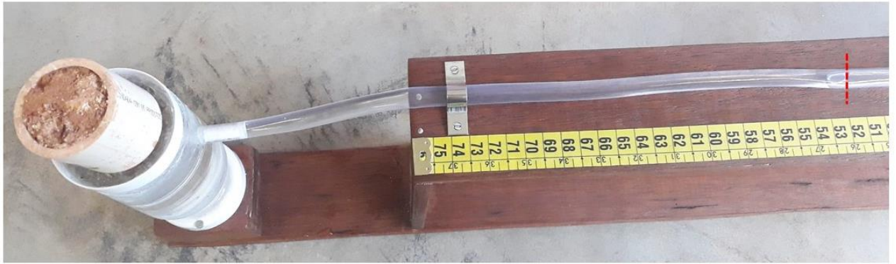
Figura 25: Final do ensaio de absorção de água. Em vermelho é indicado o nível de água após a saturação da amostra indeformada.
