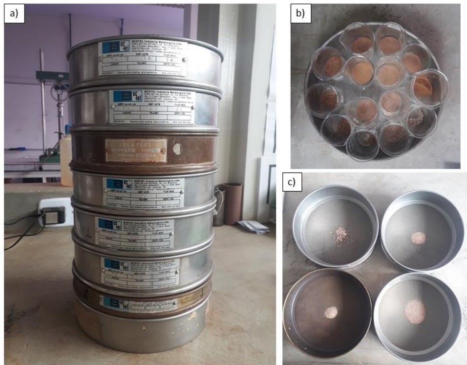
Figura 18: Processo de peneiramento fino, a) conjunto de peneiras com os diâmetros especificados, b) conjuntos de amostras após o peneiramento, c) amostras retidas nas peneiras.
