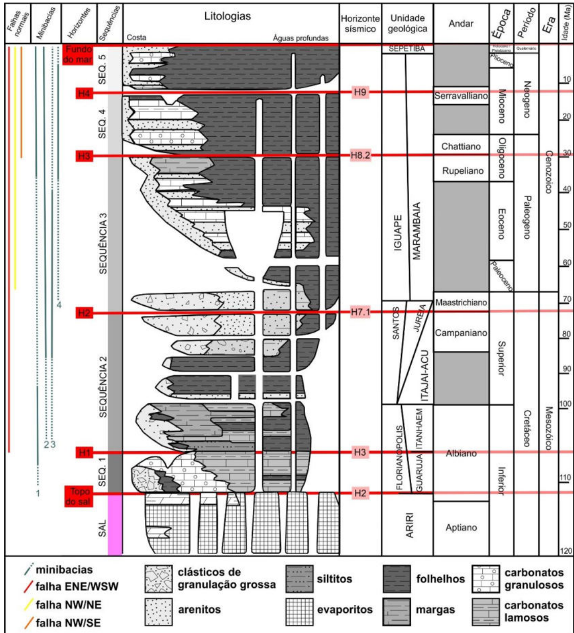
Figura 18: Correlação entre os horizontes, seqüências, minibacias (de 1 a 4 localizadas na Figura 17 e cuja a linha cheia representa a maior espessura do depocentro) e falhas normais com unidades cronoestratigráficas formais. Os horizontes sísmicos fazem referência à Assine et al. (2008). Modificada de Modica & Brush (2004) e Assine et al. (2008).
