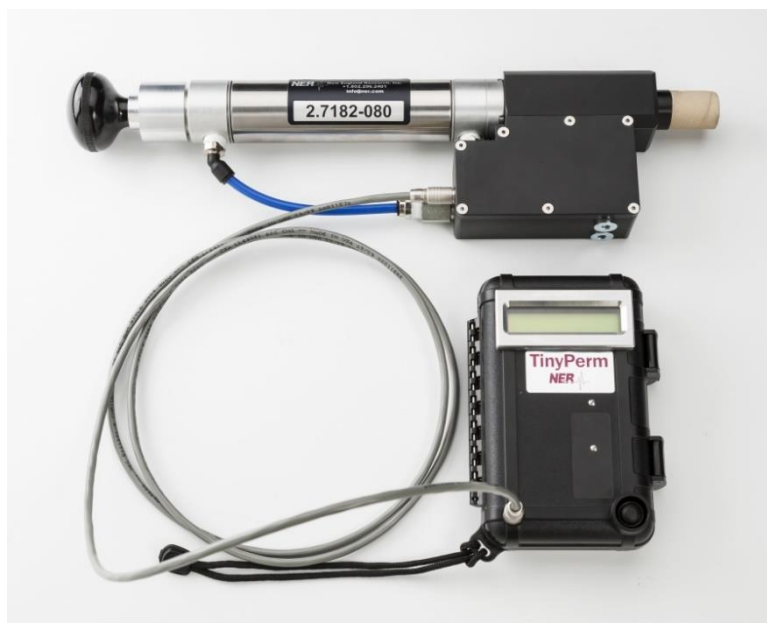
Figura 9: Equipamento Tiny Perm II fabricado pela empresa New England Research. 1) Bico de borracha que é posicionado na superfície a ser analisada; 2) Seringa; 3) Microcontrolador com display para monitorar o volume de ar na seringa e o pulso de vácuo transitório na superfície da amostra (Retirado de New England Research ).
