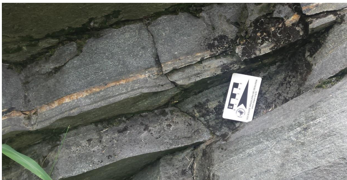
FIGURA 14: DETALHE NAS DESCONTINUIDADES DA FAMÍLIA DE FRATURA 1. FONTE: AUTORIA PRÓPRIA, 2016.
