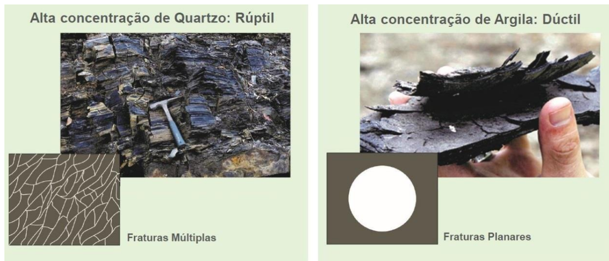
Figura 4.3: Diferença entre fraturas geradas em folhelhos rúpteis e folhelhos dúcteis (Fonte: Abelha, 2016).
