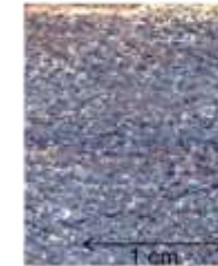
COR-9B: Mn1 - Transição do minério maciço (COR-9A) para arcóseo manganêsífero
