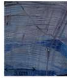
COR-55: Mn 3 , Mn metálico, maciço, com amêndoas envolvidas pela laminação
