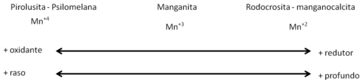
FIGURA 2 - A RELAÇÃO DA POSIÇÃO NA BACIA SEDIMENTAR E O ESTADO DE OXIDAÇÃO DO MN.
