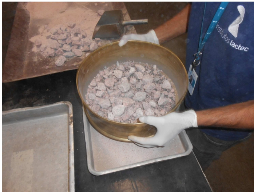
Figura 7. Material sendo peneirado, após o ensaio de abrasão.
