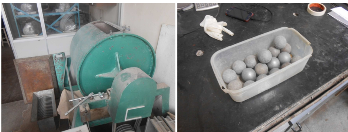
Figura 6. À direita, a máquina utilizada no ensaio de abrasão Los Angeles . À esquerda a carga abrasiva usada no ensaio.
