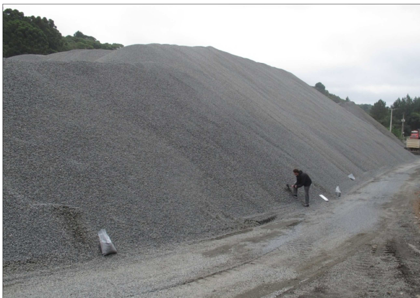
Figura 4. Amostragem em pilha, de acordo com a norma NRM NM 26.
