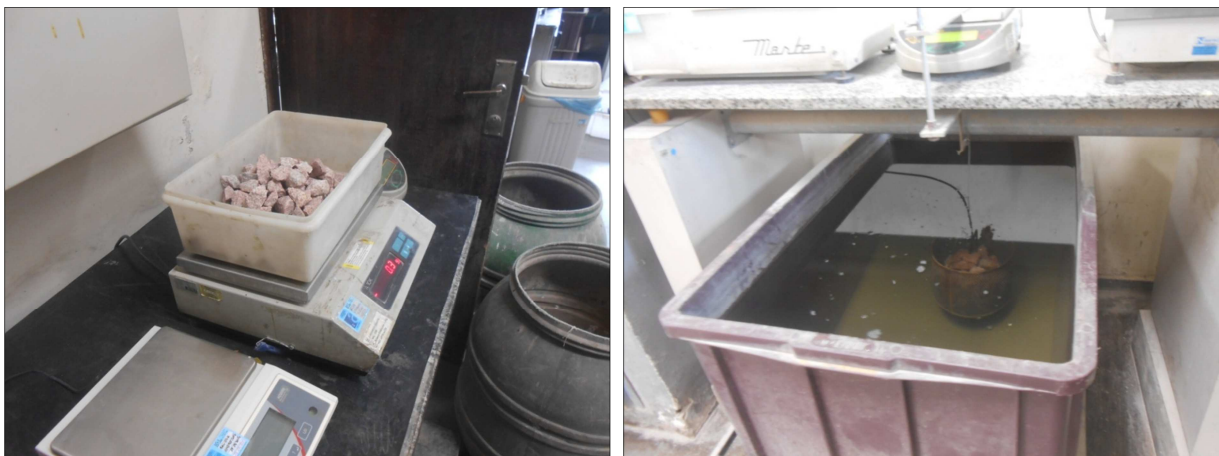
Figura 5. À esquerda, pesagem do agregado seco, à direita, o material sendo pesado em água.
