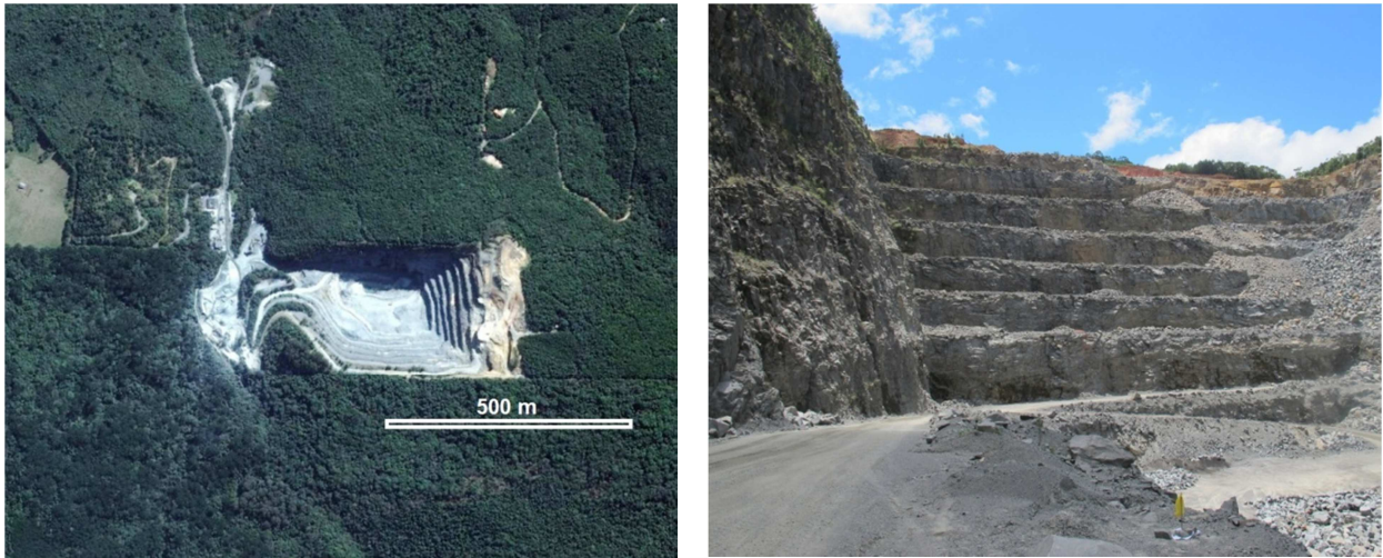
Figura 17. À esquerda cava da mineração vista em planta através de imagem de satélite (Google Earth), na direita detalhe da frente de lava e bancadas.
